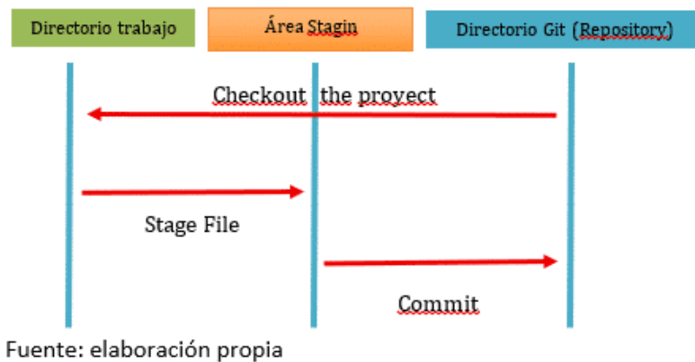
Figura 12. Flujo entre directorio de trabajo, área de preparación y repositorio en Git
