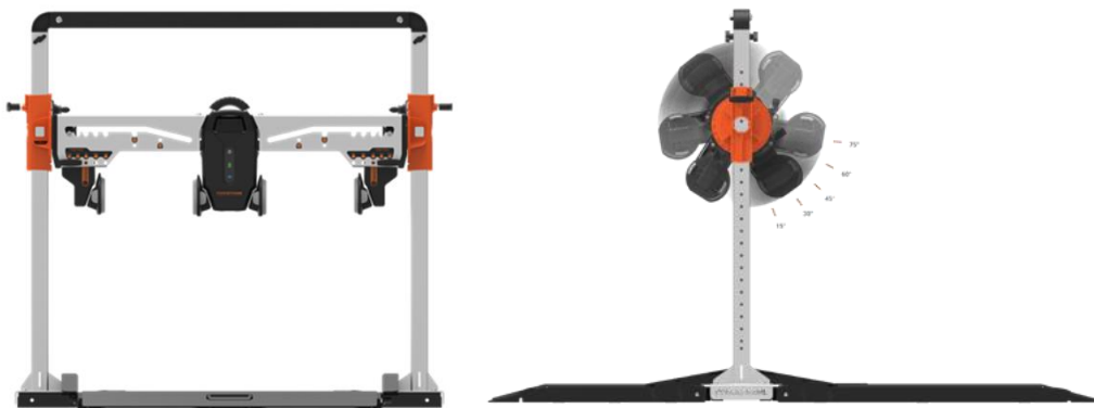
Figura 9: Forceframe y las posiciones para la evaluación de la fuerza de rotación interna y externa
