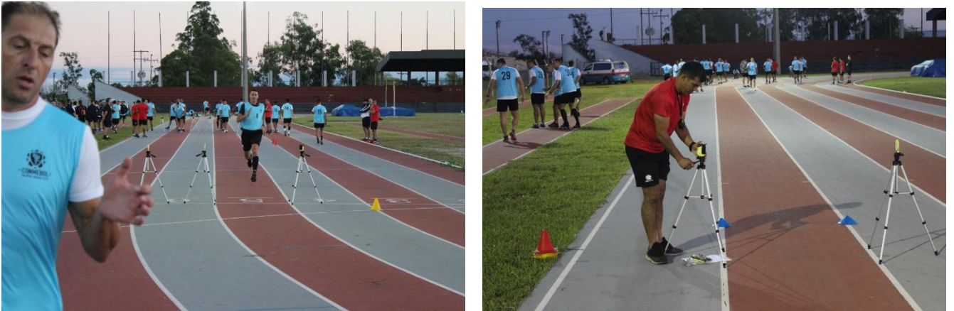
Figura 4. Celdas fotoeléctricas en uso
