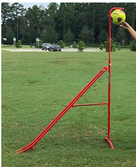
Figura 9: Rebote vertical da bola
