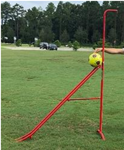
Figura 10: Teste de rolagem da bola
