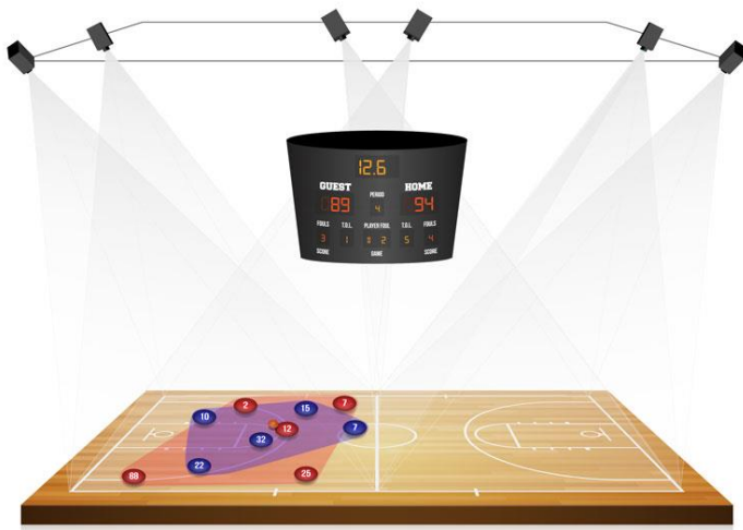
Figura 10. Sistema de multicámaras para análisis de time motion
